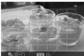
当距离测量区域的范围变窄时，您可以使用 **<>** 按键移动多点距离测量区域框的位置。
