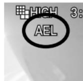
3: AEL 按键可用于在自动模式下使用指定的曝光进行拍摄。
