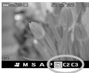
モードボタンで **C1**、**C2**、**C3** のいずれかにセットします。
