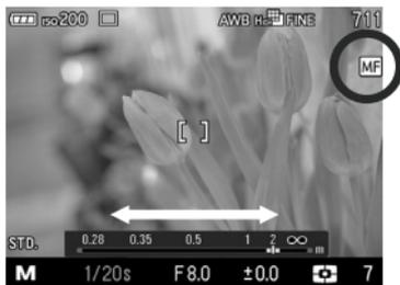
**1** **FOCUS** ボタンを数回押して、MF モードにします。(液晶モニタに **MF** アイコンとスケールバーが表示されます。)
