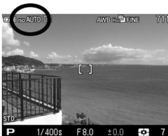
フィルムカメラで、用途に合わせて感度の違うフィルムを選ぶように、撮影時の感度を選択することができます。(ISO 感度 P.118 参照)
