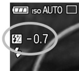
● 調光補正を設定すると、画面左側に調光補正アイコンと補正量が表示されます。
