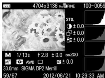
このヒストグラムは、画素の分布が明るい方向にかたよりに、右端に多くの画素が存在しています。従って露出オーバーで全体に明るめ画像であることを示しています。一般に、右側にかたよっているヒストグラムは、上記のように露出がオーバーしている場合か、もしくは適正露出でも明るい部分や明るめの被写体が画面に占める割合が大きく、明るい画素で構成された画像の場合です。
