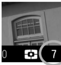
液晶モニター右下の数字はバッファ残量を示しています。連続して撮影できる最大枚数が表示されます。(連続撮影可能枚数が9枚を超える場合は 9 から変化しません。)
