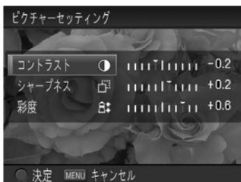
ピクチャーセッティング画面で、◆ボタンを押して「コントラスト」、「シャープネス」、「彩度」のいずれかを選択し、◀▶ボタンで調整量をセットします(0.2段ステップで±1.0まで調整できます)。
