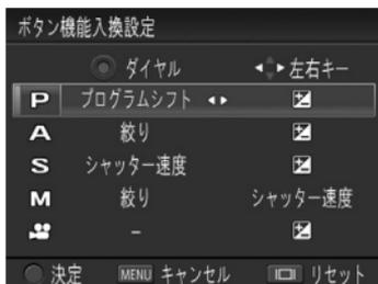
◆ ボタンで露出モードを選択し、◀▶ ボタンで機能を変更し、OK ボタンで確定します。
