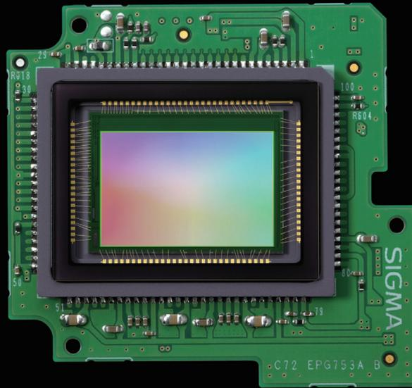
SIGMA DPに採用されているX3ダイレクトイメージセンサーは、光の波長を短い方から順に垂直方向に吸収するシリコンの特性を活かして、単板式センサーとしては世界で初めて、カラーフィルターを必要とせずにRGBの3原色が揃ったフルカラーキャプチャを実現したイメージセンサーです。
